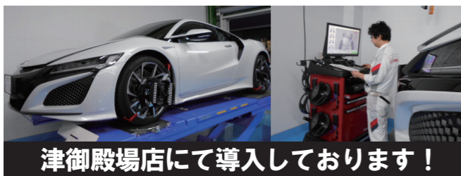
ホイールアライメントのズレによって、タイヤの寿命が短くなったり、燃費性能が損なわれる場合があります。
