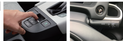
電子制御パーキングブレーキ アクセルを踏むだけで解除可能
